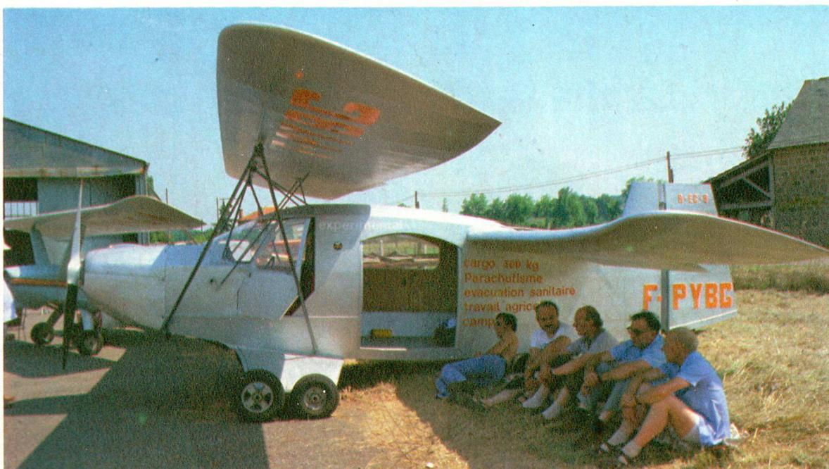
Ci-dessous, un Jurca « Sirroco » MJ-5-EA-2 avec un moteur Walter en ligne (4 cylindres) de 150 ch, turbocompresseur de suralimentation. Il a été réalisé par Ribière.
